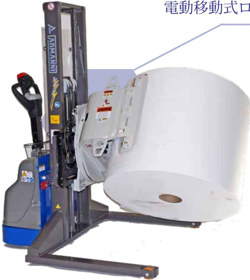
外径クランプ式によりロールを回転致します！ これらの重量物仕様クランプは、最小限の労力で重いロールにも対応出来ます。
