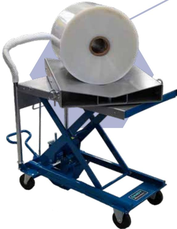
HRC ポータブル油圧式ロールハンドリングカートを使用すると、ロールやその他の重量物を最大500kgまで安全かつ簡単に移動する事が出来ます。HRC のパワフルでコンパクトなデザインは、重力でテーブルを下げるための人間工学的なハンドレバー付きの高速フットペダル作動式油圧リフトを備えています。
