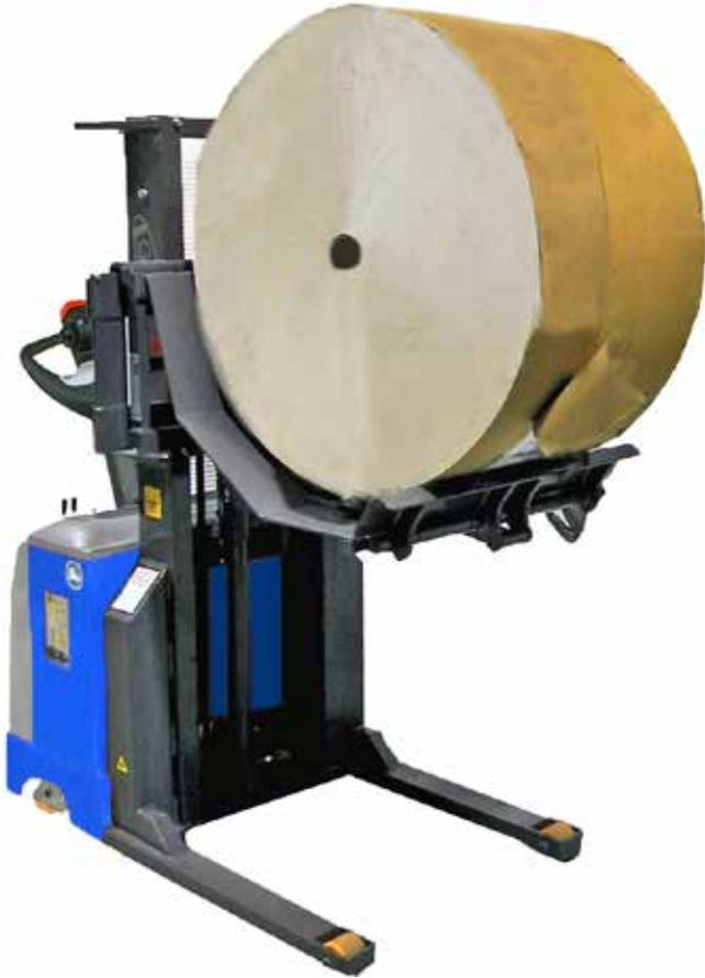
かご型ツーリング仕様の電動移動式リフトトラックは、大きなロールを簡単に動かす事が出来ます。動力付きの駆動および昇降機能を使用すると、色々な作業を行う事が出来ます。
